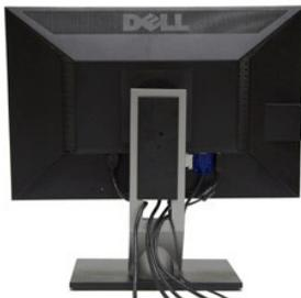
Después de conectar todos los cables necesarios al monitor y al PC, (consulte [Conectar su monitor](#) para conectar los cables), utilice la ranura de sujeción de cables para organizarlos correctamente tal y como se muestra arriba.
